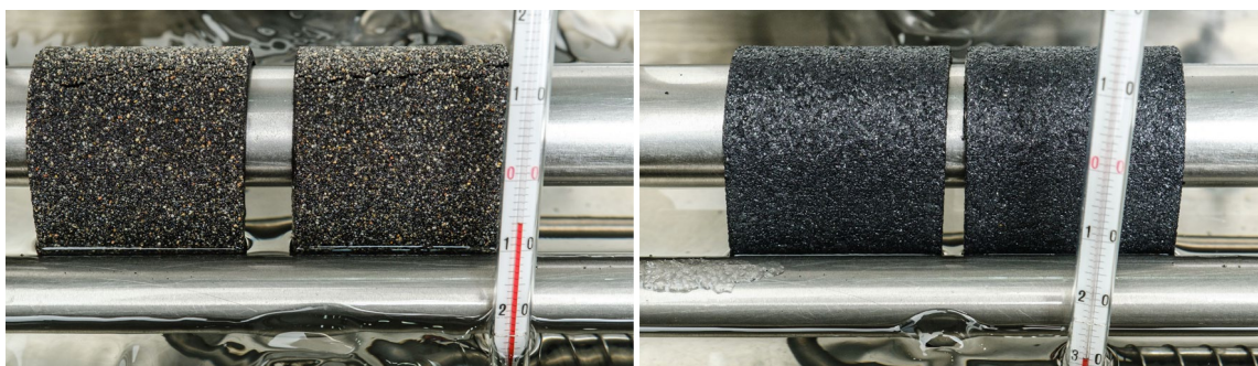
Kaltverbiegeverhalten nach DIN EN1109: Links ein Standard-Produkt nach 60 Minuten im Kältebad bei -5 °C – mit dem Ergebnis der sichtbaren Rissbildung. Rechts eine Hasse Vapor nach 60 Minuten im Kältebad bei -30 °C – ohne Beeinträchtigung der Funktionalität.
